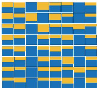
图 5 数据叠加导频模式下资源块中数据与导频符号的传输形式
