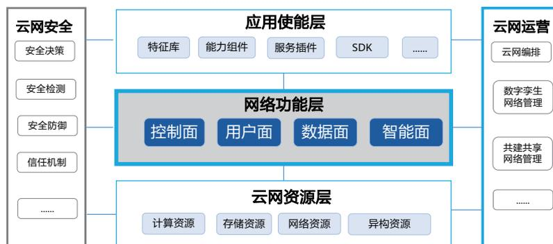
图 1 6G 网络分层架构
